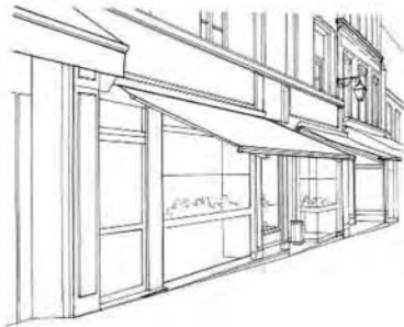
Le porte-à-faux des coffres et des corniches des devantures en bois permettent d'inscrire les rouleaux de bannes et tringleries
