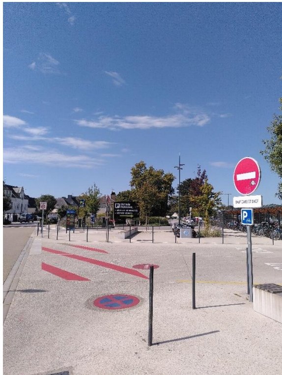
Signalisation horizontale et verticale pour protéger l'accès à la gare routière des stationnements sauvages
